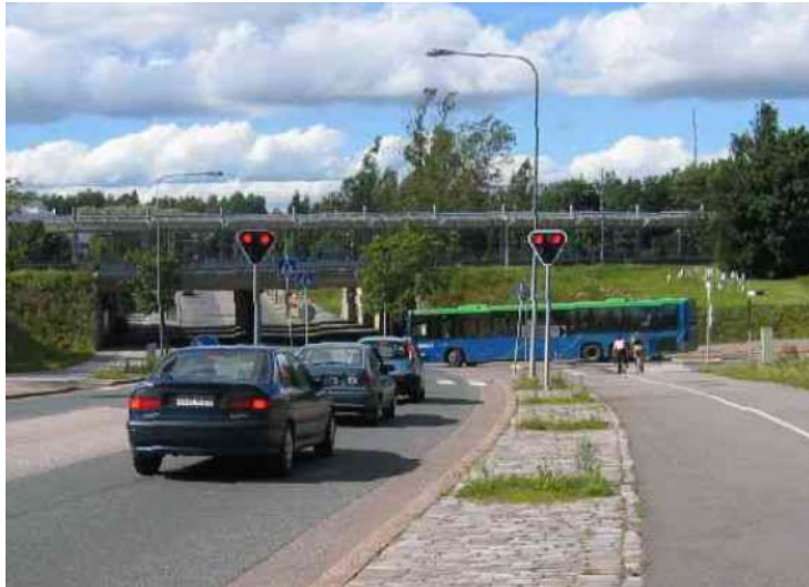
Abb. 10: Der Bus hat dank einer Ampelanlage, welche an den örtlichen Bahnübergangssignalen angelehnt ist, freie Fahrt vom Busbahnhof auf die Strasse (Bild: http://www.uitp-bhls.eu/ )
